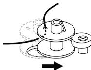
1. Posizionare il rocchetto di filo ed il ferma spola all'interno del porta spola orizzontale. Scegliere il ferma spola (grande o piccolo) in base al diametro del rocchetto di filo spingendolo contro il rocchetto fino a farlo aderire ad esso.
