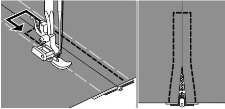
Eseguire una cucitura a 45° girando orizzontalmente sopra la parte finale della cerniera lampo.
