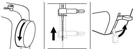
8. Terminata la cucitura, rilasciare il pedale di comando (reostato), ruotare il volantino verso sè e rimuovere la stoffa da sotto al piedino.
