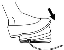
7. Avviare la macchina attraverso il pedale di comando (reostato).
