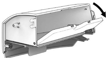
La parte anteriore dell'allunga base viene utilizzata per riporre gli accessori forniti in dotazione. Per aprire lo sportellino del vano tirarlo in basso.
