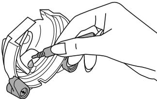
Lubrificare l'area interna del vano crochet con alcune gocce di olio specifico per macchine per cucire; ruotare il volantino verso sè di un giro completo per distribuire l'olio in tutta l'area.
