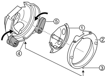
Rimontare i componenti posizionandoli come mostra la figura a fianco: per primo il crochet quindi il ferma crochet (lo sperone inferiore deve incastrarsi al relativo incavo posto sul bordo del vano crochet).
