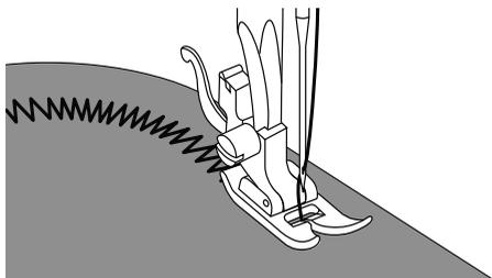
Selezionando il punto zigzag si raccomanda di impostare una lunghezza punto ravvicinata per facilitare l'operazione di cucitura lungo la curva.
