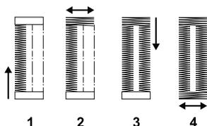
Attraverso il selettore punto eseguire i 4 passaggi che compongono l'asola, procedendo da 1 a 4. Prima di ruotare il selettore per procedere da un passaggio all'altro, accertarsi che l'ago si trovi nella sua posizione più elevata. Per eseguire i passaggi 2 e 4 sono sufficienti 3 o 4 punti di cucitura.
