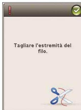
7. Completato il primo colore, la macchina taglia il filo superiore e si arresta. Viene visualizzato un messaggio popup che chiede di cambiare colore. Infilare la macchina con il colore successivo e continuare a ricamare premendo Avvio/Arresto. Mantenere il capo del filo. La macchina taglia il filo superiore e si potrà tirarla.
