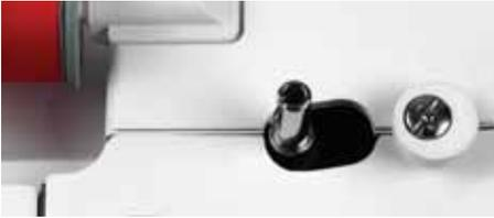
Tenere saldamente l'estremità del filo e premere il pedale. Fermare la macchina quando la bobina ha completato più giri e tagliare l'estremità libera del filo vicino alla bobina.
