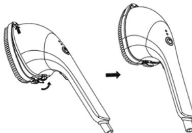
Platte aufsetzen, dann den hinteren Teil aufziehen, bis er mit dem Clip an der Platte befestigt wird. Um die Bürste abzunehmen, lösen Sie den Clip, heben Sie die Bürste an und nehmen Sie sie vollständig ab.
