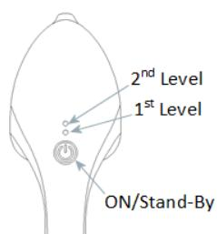
Licht und das Bügeleisen erwärmt sich auf die Temperaturstufe 1, die entsprechende LED blinkt während des Heizens und nach Erreichen der Temperatur bleibt das LED-Licht konstant an: Der Dampf kann austreten und man kann mit dem Bügeleisen bügeln. Vermeiden Sie es, die Dampftaste zu drücken, wenn der Wassertank leer ist.
