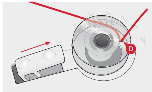
*Nota: assicurarsi che il filo sia tirato saldamente all'interno del dispositivo di pretensionamento per una corretta tensione del filo.*
