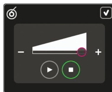
Quando la bobina si è avvolta completamente, la leva carica bobina si disinserisce e il caricamento si arresta automaticamente. Il popup si chiude. Togliere la bobina e tagliare il filo con il taglia-filo. Tagliare l'estremità libera del filo accanto alla bobina.
