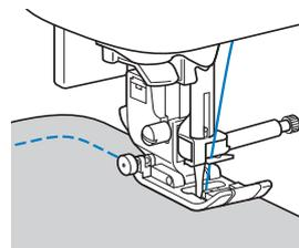
Se si cuce lungo una curva utilizzando il punto a zig-zag, selezionare una lunghezza del punto inferiore per ottenere un punto più sottile.
