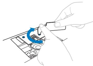
Ruotare il volantino per controllare che la griffa di trasporto si muova in modo uniforme e non tocchi i bordi delle fessure nella placca ago.
