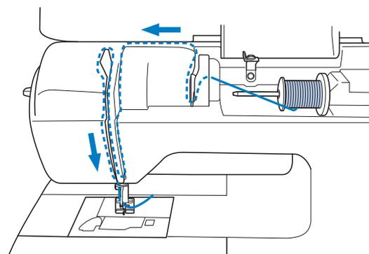
→ Seguire attentamente le istruzioni quando si esegue l'infilatura del filo superiore.
