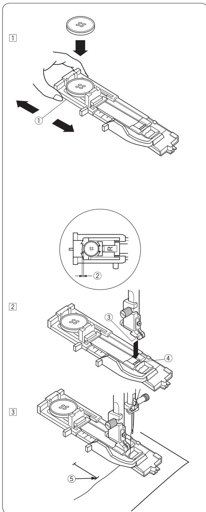
La dimensione dell'asola viene determinata automaticamente posizionando un bottone dietro al piedino R per asole automatiche.
