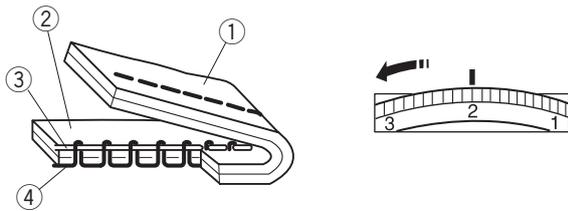
Per diminuire la tensione, portare la rotella di regolazione della tensione del filo su un valore più basso.
