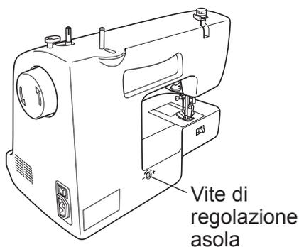
Se i punti sono allentati sul lato destro dell'asola, ruotare leggermente in direzione “-”.
