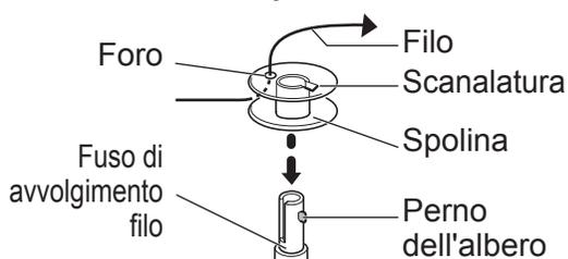
**5** Far scivolare il fuso di avvolgimento filo in direzione della freccia finché non scatta in posizione.
