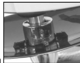
Druk het hulpstuk naar beneden en draai het tegelijkertijd tegen de wijzers van de klok in, zodat de spie vast komt te zitten in de aandrijfas.
