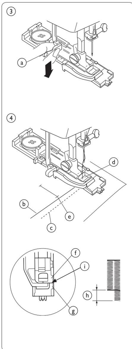
5. Cucire lentamente. La macchina cuce l'intera asola. Arrestare la macchina per cucire in corrispondenza del punto di inizio una volta completata l'asola.
