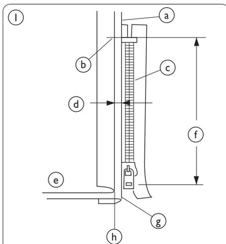
2. Posizionare i denti della cerniera vicino alla piega e appuntare in posizione. Allineare il piedino per cerniere con la piega. Ripristinare le impostazioni iniziali della tensione del filo e della lunghezza del punto. Eseguire una cucitura lungo tutta la lunghezza del nastro della cerniera, togliendo gli spilli man mano che si procede.
