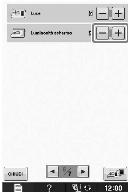
\* Diminuendo il valore delle impostazioni, la luminosità dello schermo diminuisce. Aumentando il valore, la luminosità dello schermo aumenta.
