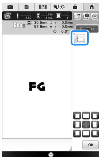
→ L'ago è posizionato nell'angolo inferiore sinistro del ricamo. Il telaio per ricamo si sposta in modo che l'ago sia posizionato correttamente.
