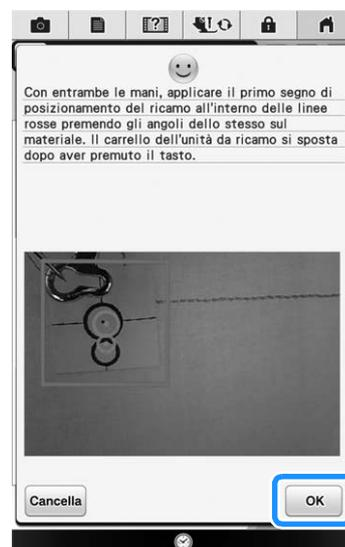
→ Premere **OK** in modo che la fotocamera rilevi il primo adesivo di posizionamento.
