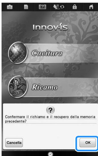
→ Viene visualizzata la schermata di ricamo precedente visualizzata prima dello spegnimento della macchina.
