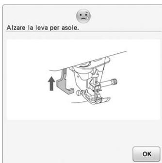
Questo messaggio viene visualizzato quando la leva per asole è abbassata, si seleziona un punto diverso dall'asola e si preme il pulsante "Avvio/Stop" o il pulsante "Punti di fermatura/rinforzo".
