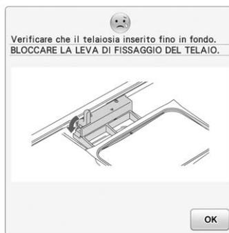
Questo messaggio viene visualizzato quando il telaio per ricamo è montato.
