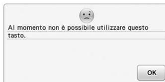
Questo messaggio viene visualizzato quando si preme **Guida Alla Cucitura** in una schermata diversa da Punto utile o quando si preme **Spiegazione Dei Disegni** in una schermata diversa da Punto utile o Carattere/ Punto decorativo.
