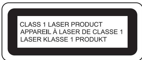
Il raggio laser emesso dall'unità laser installata in questa macchina è limitato a un livello di uscita sicuro. Tuttavia, la macchina contiene diodi laser InGaAlP da 6 mW, lunghezza d'onda 630-640 nm, angolo di divergenza parallela 6-12° e angolo di divergenza perpendicolare 24-34°. Pertanto, lo smontaggio o la modifica di questa macchina può causare danni agli occhi. Sono state studiate precauzioni di sicurezza per prevenire ogni possibile esposizione dell'operatore al raggio laser.
