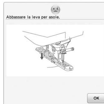
Questo messaggio viene visualizzato quando la leva per asole è in posizione sollevata, si seleziona un punto per asole e si preme il pulsante “Avvio/Stop” o il pulsante “Punti di fermatura/rinforzo”.
