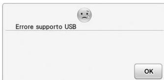
Questo messaggio viene visualizzato quando si verifica un errore a carico del supporto USB.
