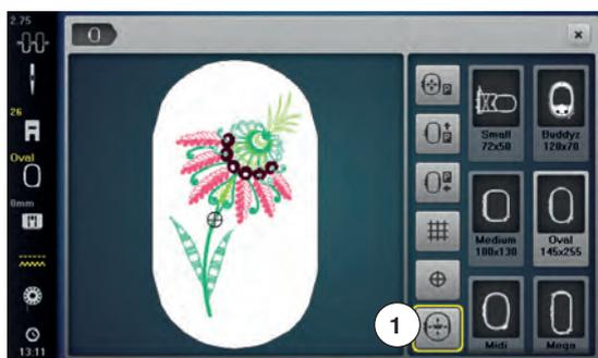
Con la penna touchscreen o con il dito è possibile selezionare qualsiasi parte del ricamo direttamente sul display «Edit».
