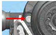
Dopo la lubrificazione portare il crochet nella posizione corretta per l'infilatura (vedi illustrazione a sinistra), girando il volantino in senso orario.
