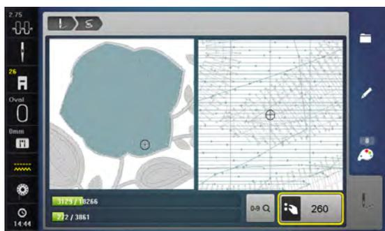
La parte sinistra del display visualizza la dimensione normale del ricamo e del colore attuale, la parte destra mostra l'ingrandimento del ricamo. Questa rappresentazione rende più facile il controllo del percorso del ricamo.
