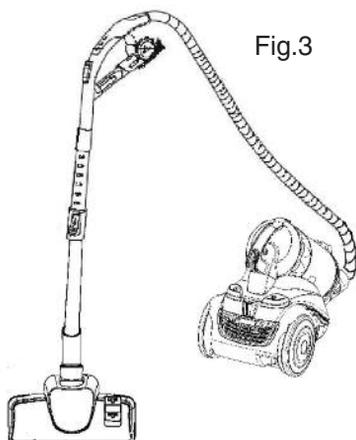
scopico nell'estremità del tubo flessibile come mostrato in figura 3 ; quindi fissare la spazzola pavimenti/moquette al tubo telescopico. A questo punto l'assemblaggio sarà completato.
