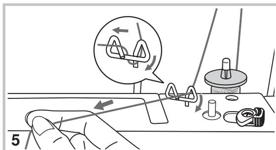
5. Posizionare il filo attraverso l'apposita apertura del guidafilo del portarocchetto utilizzato.
