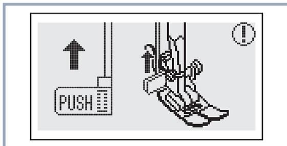
**Nota:** se la leva per occhielli è abbassata e il punto selezionato non è quello per le asole, sul display LCD appare un messaggio di avvertenza animato che ricorda di sollevare la leva, premendo il tasto AVVIO/ARRESTO o il comando a pedale.
