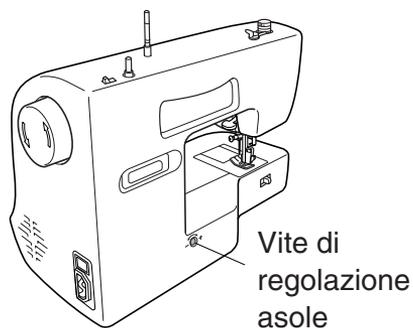
Se i punti sono allentati sul lato destro dell'asola, ruotare leggermente in direzione “-”.
