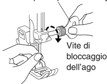
**3** Inserire l'ago con la superficie piatta rivolta verso il retro fino a che non entra in contatto con il perno. Stringere saldamente la vite di bloccaggio dell'ago con il cacciavite per la piastra dell'ago.
