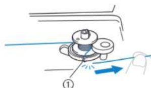
① Fente du guide de la base du bobineur de canette (avec coupe-fil intégré)
