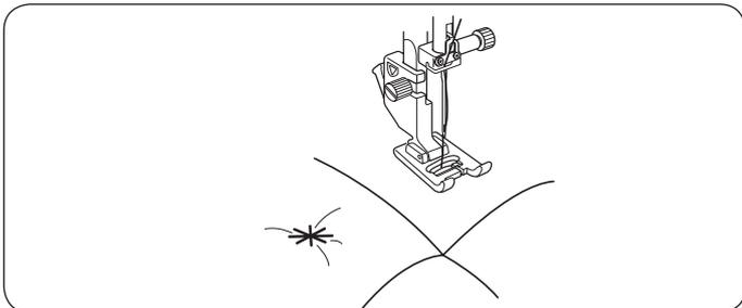
Vous pouvez refermer les couches de quilt en utilisant un point fermoir. Sélectionnez le motif de point 106. Appuyez sur la touche mémoire. Sélectionnez le motif L.S. Commencez à coudre. La machine coud un point fermoir et un point d'arrêt avant de s'arrêter automatiquement.
