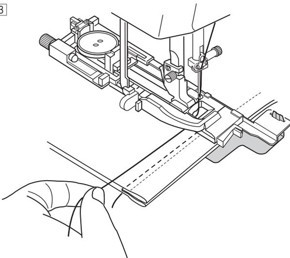
3 Abaissez l'aiguille à l'emplacement où vous souhaitez commencer en tournant le volant. Abaissez le levier du pied et de la boutonnière. Démarrez la machine.
