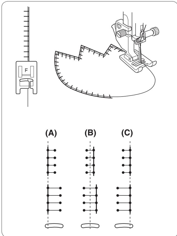
Placez un appliqué sur le tissu et maintenez-la en place au moyen d'un bâti ou utilisez un entoilage thermofusible pour que l'appliqué reste bien en place.
