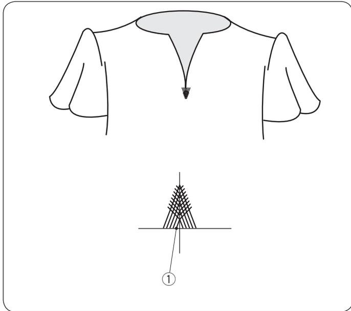
La bride est un point d'arrêt de forme triangulaire qui s'utilise à la base des braguettes ainsi que pour les poches revolver des pantalons masculins.
