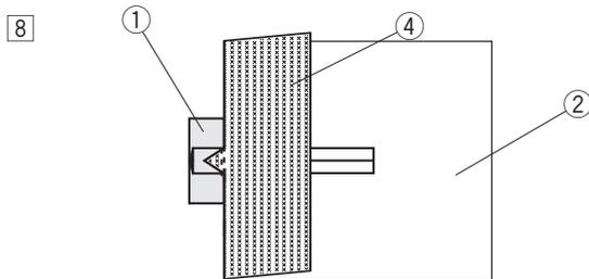
8 Pliez par dessus l'extrémité du tissu du vêtement et cousez en marche avant et arrière par trois fois par dessus l'extrémité triangulaire.
