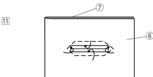
11 Retournez toutes les couches de tissu et découpez l'ouverture de la boutonnière sur le revers de la même façon que lors de l'étape 2. Les quatre épingles de marquage désignent les points des angles sur le revers. Repliez chaque pan de tissu entre le revers et le morceau de tissu.
