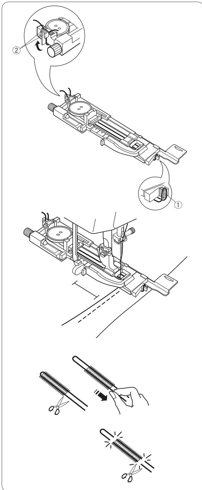
Avec le pied pour boutonnière automatique R relevé, suspendez la corde de remplissage à l'aiguillon situé sur l'avant du pied pour boutonnière.
