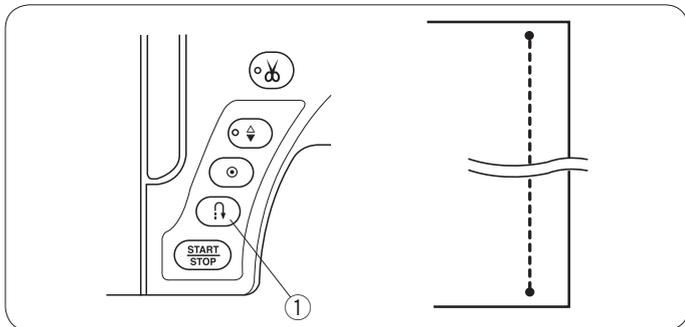
Ce point spécial est utile lorsqu'un point de blocage invisible est nécessaire. Abaissez l'aiguille à proximité du bord avant du tissu.
