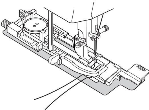
2 Placez le bouton sur le porte-bouton situé sur le pied. Fixez le pied pour boutonnière à la machine. Insérez le tissu entre le pied pour boutonnière et la plaque de stabilisation. Appuyez deux fois sur la touche de position haute/basse de l'aiguille puis déplacez le tissu sur la gauche afin d'amener les fils de l'aiguille et de la canette entre le pied et la plaque de stabilisation.
