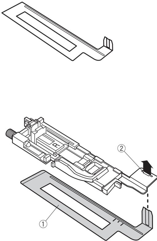
1 Insérez l'onglet de la plaque de stabilisation (1) dans l'encoche du pied pour boutonnière.
