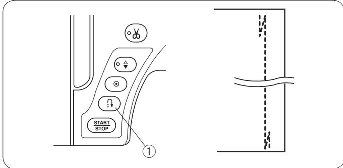
Ce point sert à consolider le début et la fin d'une couture avec le point arrière. Lorsque vous atteignez l'extrémité d'une couture, appuyez une fois sur la touche de point arrière ①. La machine coud alors quatre points en marche arrière, quatre points en marche avant, avant de s'arrêter de coudre automatiquement.
