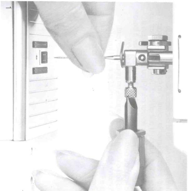
Pousser l'aiguille à fond en haut jusqu'à ce qu'elle soit engagée. (Si ce n'est pas le cas, il peut se produire des points manqués.) Bien serrer la vis de fixation de l'aiguille.
