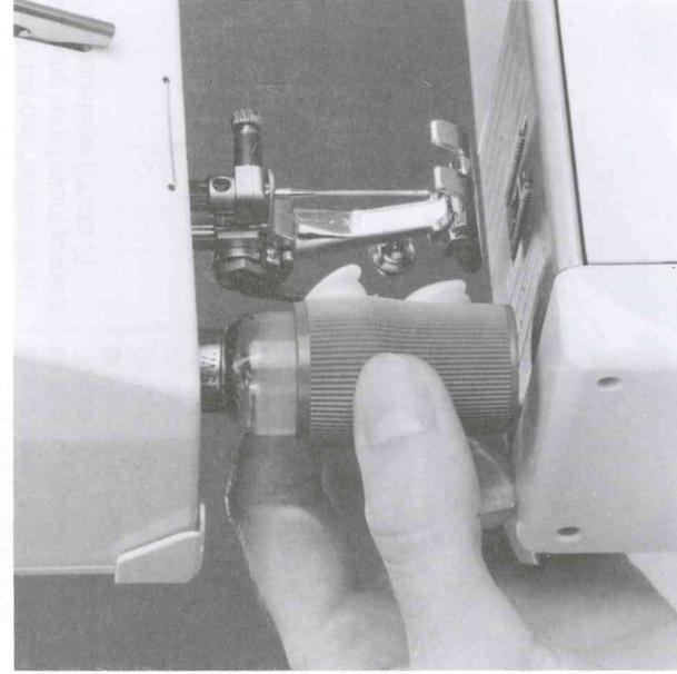
Pour mettre en place les nouvelles ampoules: Placer la nouvelle ampoule sur la douille spéciale.
