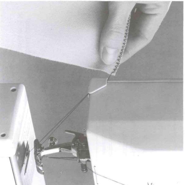
Au moment d'enlever l'ouvrage, mettre le pied-de-biche vers le haut. Vérifier que l'aiguille est en haut, sinon, faire tourner le volant. Retirer l'ouvrage vers la gauche à l'arrière et faire passer les deux fils dans le coupe-fill. Lors du début de la couture, les fils se dégagent tout seuls.
