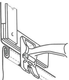
d) Pour compenser devant le pied-de-biche, placer une ou plusieurs plaquettes à la droite du pied au ras de l'aiguille. Coudre sur la zone épaisse, puis retirer les plaquettes.
