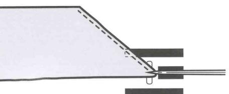
c) Pour obtenir un entraînement horizontal, placer une ou plusieurs plaquettes à la droite du pied-de-biche en affleurant le tissu dans l'angle.
