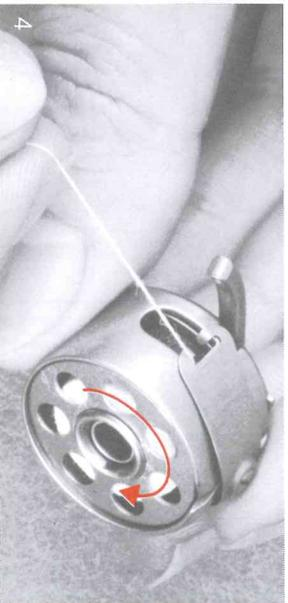
En tirant sur le fil, la canette doit tourner dans le sens des aiguilles d'une montre, voir flèche.
