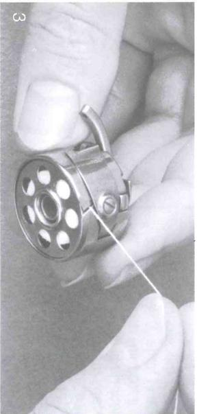
Tirer le fil dans la fente et sous le ressort jusqu'à ce qu'il se place dans la fente en forme de T à l'extrémité du ressort.
