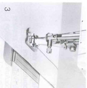
cououdre des largeurs intermédiaires au moyen des positions de l'aiguille gauche, mi-gauche, droite, mi-droite.
