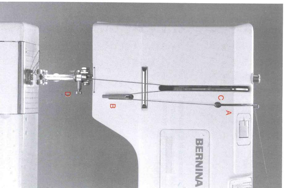
Sur la face avant de la machine, amener le fil hors de la tente **A** vers le bas. L'introduire dans le régulateur de fil **B** puis en haut dans la fente du tendeur de fil **C** redescendre jusqu'au guide **D** au niveau du porte-aiguille.
