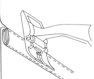
c) Pour compenser cette hauteur (épaisseur), placer une, deux ou trois plaquettes de compensation derrière l'aiguille et sous le pied-de-biche.
