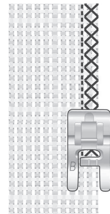
Izquierda: Elástico grueso y pespunte/sobrehilado. Derecha: Tejido y costura gruesos/sobrehilado.
