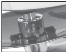
4. En el extremo superior del accesorio verá un receso para el eje motor y el pasador. Coloque el accesorio necesario introduciendo el extremo superior en el eje motor (12). Empuje y gire el accesorio simultáneamente en sentido contrario a las agujas del reloj, de forma que el pasador encaje en posición en el eje motor.
