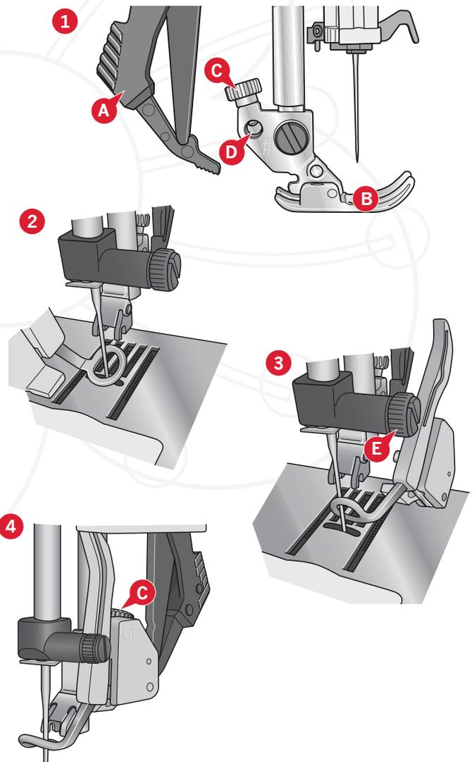
Pour retirer le pied de broderie, desserrez la vis (C), empoignez le pied et tirez dessus vers la droite pour qu'il sorte. Serrez la vis.
