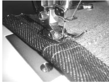
Piquez à la position la plus haute, l'aiguille reste dans le tissu ; ensuite, comme indiqué sur l'image, placez un morceau de jean sous le pied (le pli est dû à la différence de hauteur). Cousez doucement point par point, la machine à coudre a toute la puissance pour piquer. Maintenant pendant que vous cousez, cousez point après point poussez doucement et ne tirez pas sur le tissu !
