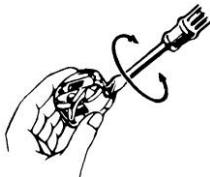
La tension du fil inférieur se règle en tournant la vis de la canette. Elle (la tension) sera augmentée en tournant la vis à droite, dans le sens de la montre. Elle sera diminuée en tournant la vis à gauche, contre le sens de la montre.
